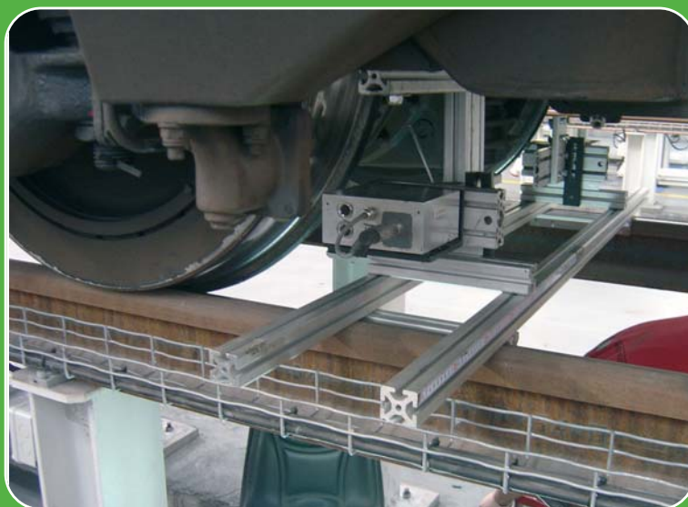
Un sistema de rayos infrarrojos montado en un eje transversal lee la vía buscando desgastes excesivos.
